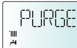
3. Attivare il ciclo di disareazione premendo il tasto ESC per 5 secondi. La caldaia inizierà un ciclo di disareazione di circa 7 minuti che può essere interrotto, se necessario premendo il tasto ESC. Al termine verificare che l'impianto sia completamente disareato e, in caso contrario, ripetere l'operazione.
