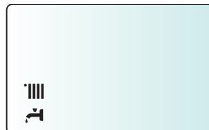
2. Accendere la caldaia (premendo il tasto ON/OFF) e selezionare la modalità stand-by - non ci sono richieste né dal sanitario né dal riscaldamento;
